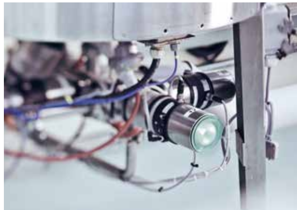
Bodenablassventilsystem mit integriertem Füllstandssensor an einem Ansatztank für Unither Pharmaceuticals.
