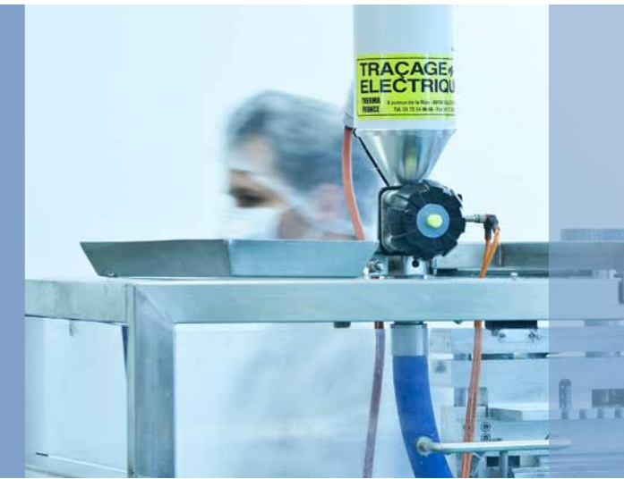
An der Fertigungsstraße: Manuelles Membranventil mit integrierter elektronischer Rückmeldung
